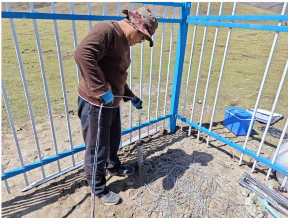
深孔温度链安装图
