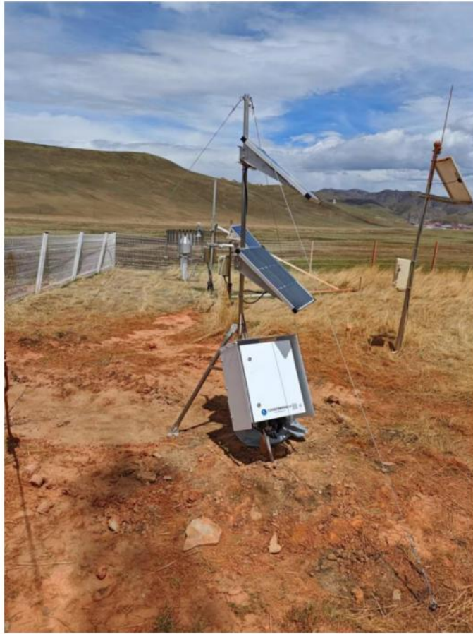
深孔温度链安装图
