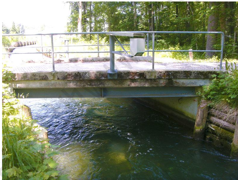
图 1 RQ-30 非接触式雷达流速仪
