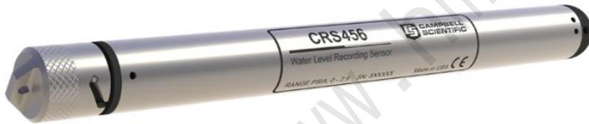
作为 CS450 的升级型号，CS451/456 水位传感器缩短了进水口与隔膜的间距，进一步降低了其中的残留空气量，从而减小了残留空气在融入水中时测量准确性的影响。它具备  $\pm 0.1\%$  FS 的标准精度，您也可以选择  $\pm 0.05\%$  FS 高精度（不支持  $0\sim 2.9$  psig）。
