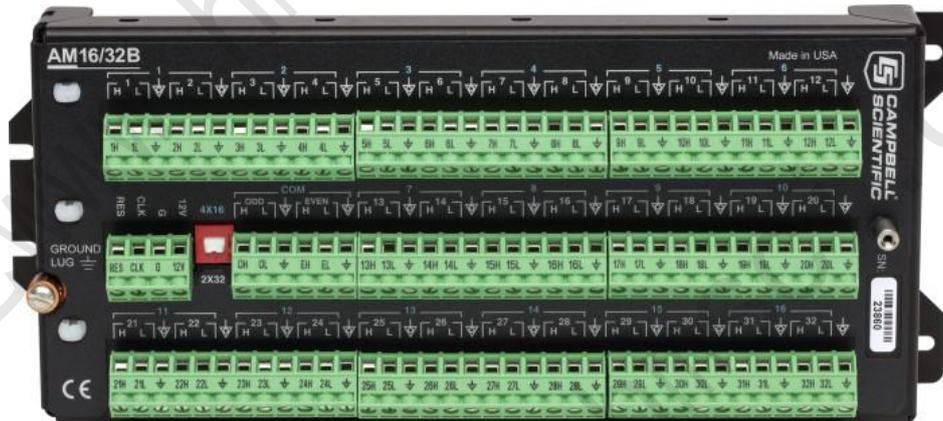
AM16/32B 扩展板增加了**数据采集器**可以测量的传感器的数量。AM16/32B 可以通过 4 个复用端口（COM）顺序地切换测量 16 组 4 线制的传感器（共 64 线）。另外，用手动转换开关可以把 AM16/32B 切换到 2 线模式，来顺序测量 32 组 2 线制传感器（总数同样为 64 线）。
