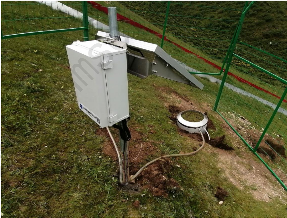
图 1 微型蒸渗仪草地安装图
